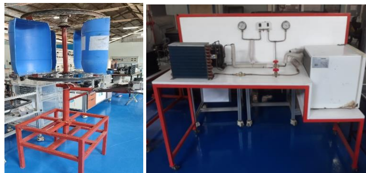
Gambar 3. Sistem instalasi turbin angin untuk freezer
