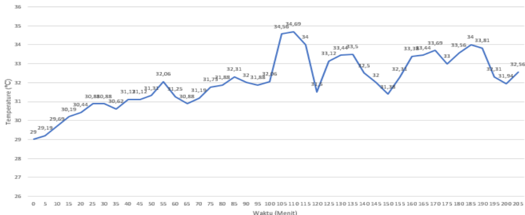
Gambar 5. Grafik Hubungan Temperatur inkubator terhadap waktu dengan lampu 25 watt
