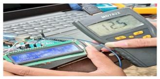
Gambar 6. Hasil percobaan alat ukur menggunakan jembatan wheatstone dengan gabah kering
