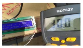
Gambar 7. Hasil percobaan alat ukur menggunakan jembatan wheatstone dengan gabah basah
