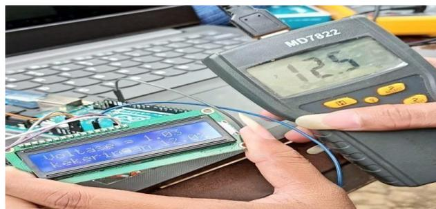
**Gambar 6.** Hasil percobaan alat ukur menggunakan jembatan *wheatstone* dengan gabah kering
