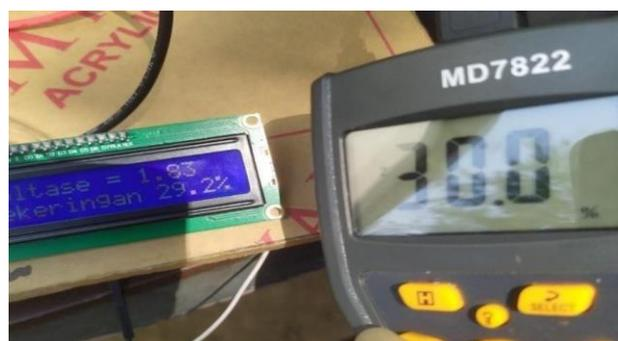
**Gambar 7.** Hasil percobaan alat ukur menggunakan jembatan *wheatstone* dengan gabah basah
