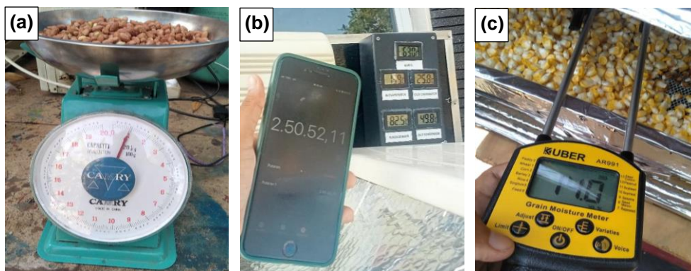
Gambar 3. Proses pengeringan produk hasil panen. (a) mengukur massa produk sebelum dikeringkan, (b) mengukur temperatur produk saat dikeringkan, dan (c) mengukur kadar air produk setelah dikeringkan dengan menggunakan moisture meter .
